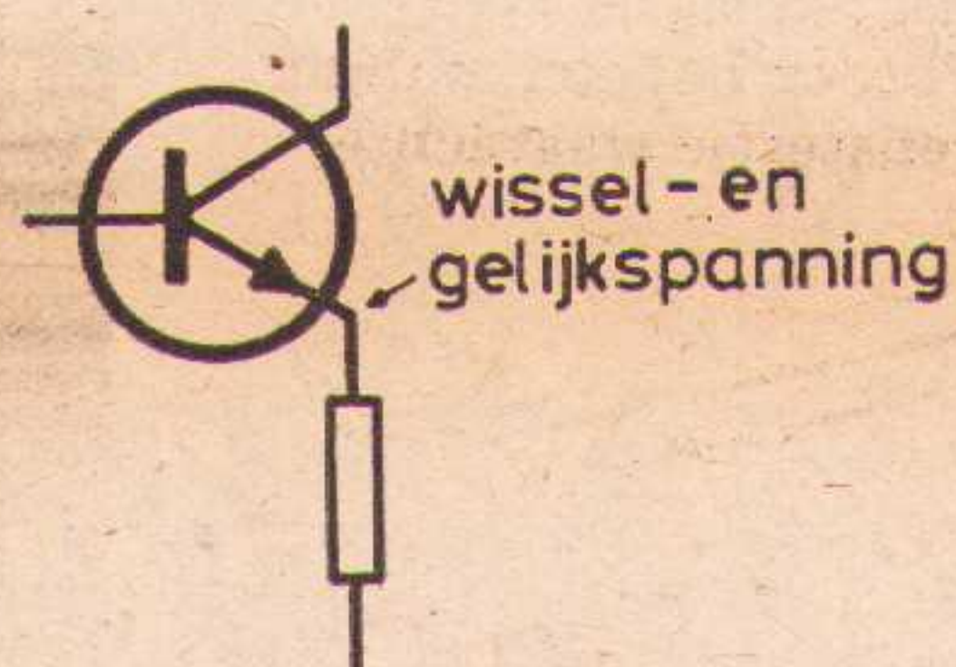
Op de emitter staat gelijk en wisselspanning
